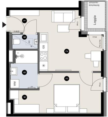
PH Parapetenhöhe | GH Gesäulderhöhe | BH Brüstungshöhe | RH Raumhöhe | UZ Unterzug | VK Vorderkante | AD Abgehängte Decke
